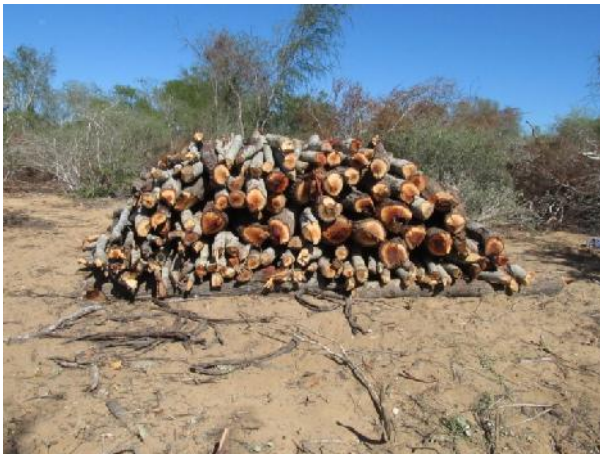
Photo 3 : Disposition des bois dans la meule selon la technique traditionnelle
