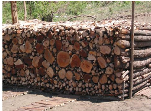
Photo 4 : Disposition des bois dans la meule selon la technique améliorée
